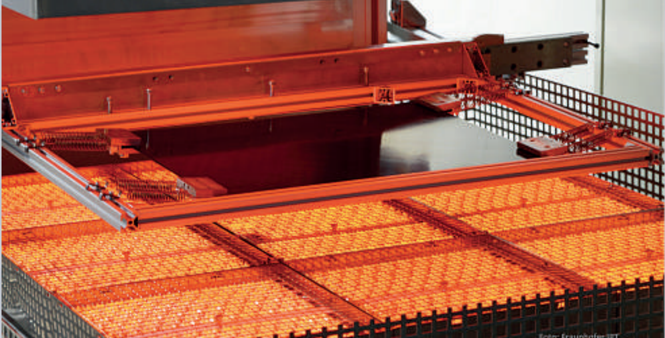
Spezialität der Krelus AG: Der Infrarotstrahler erwärmt eine Fläche schnell und temperaturgenau. (Bild: Fraunhofer IPT)
