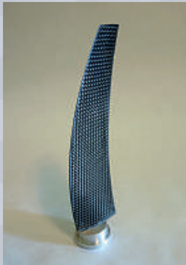
Besondere Herausforderung: Hochbelastetes Miniatur-Propellerblatt für Windkanalversuche in Carbon-Bauweise.
