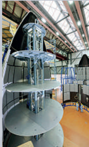
Kohlefaserverbund: Montage von Ariane- und Atlas-Nutzlastverkleidungen in Emmen.
