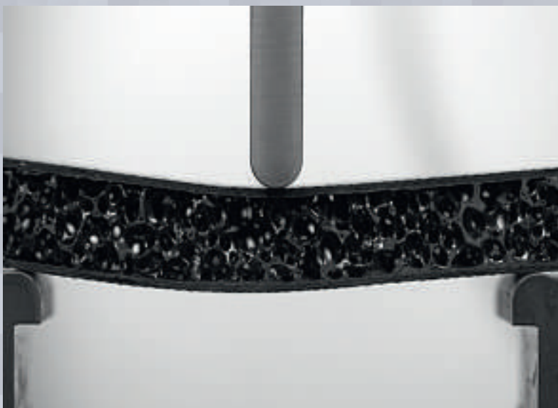
Belastungstest eines thermischen Schutzschildes aus Silikoncarbid für Raumfahrzeuge. (Bilder: Supsi)
